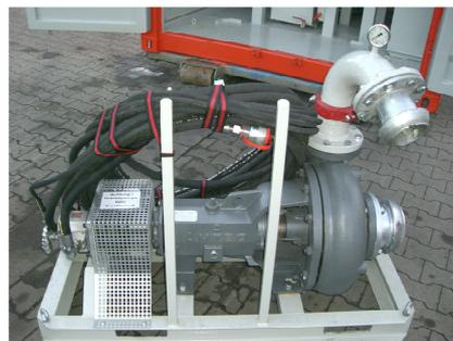
Hydraulisch Angetriebene Kreiselpumpe zum Füttern der Hochdruckpumpe, wird automatisch beim Einschalten der Hochdruckpumpe über Elektrisches DBV mit eingeschaltet. Durch Hydraulikschraubkupplung ist diese nach Ende der Arbeit einfach vom Container zu trennen und zu transportieren.
